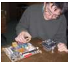
Slika 9. CPU - Centralni procesor (CPU) i demonstracija ugradnje CPU na matičnu ploču
