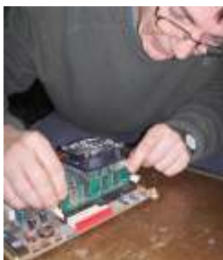
Slika 11. Kartice RAM-a i demonstracija instalacije kartice RAM-a (Random Access Memory) na matičnu ploču.
